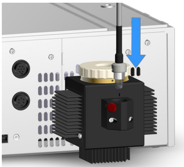
Рисунок 13 Вставка лампы видимой части спектра
